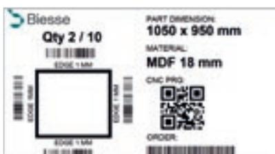
Alle Informationen zum einzelnen zu optimierenden Unterformat werden auf ein Etikett mit personalisierbarem Layout gedruckt.
