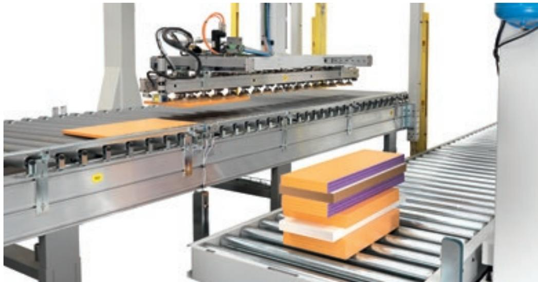
La gamme Matrix permet d'exécuter en séquence, sans temps de configuration, une charge de travail sur commande. C'est la machine idéale pour le fabricant de meubles, à intégrer dans des flux tendus. Dans la version à insertion seule, elle est particulièrement adaptée pour être combinée avec la perceuse Insider.
