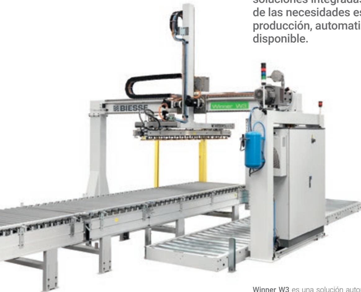
Winner W3 es una solución automática que permite cargar y descargar los paneles en líneas flexibles de perforado para la gestión de pilas bajo pedido.
