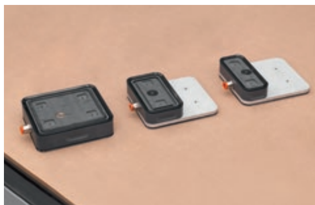
真空吸盘可直接固定板件，且在没有真空辅助系统的情况下，也能快速和简易地使用。
