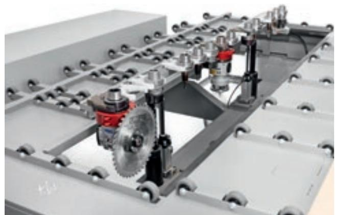
O depósito integrado na base da máquina garante a disponibilidade das ferramentas mesmo com soluções de carga automática, com um volume mínimo.
