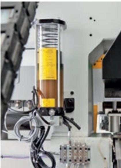
A **lubrificação automática** é uma opção que garante uma lubrificação contínua dos principais órgãos de movimentação da máquina, sem que seja necessária a intervenção do operador.
