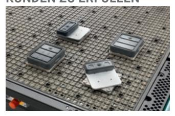
Arbeitstisch aus Phenol-Schichtstoff mit Vakuumanlage.
