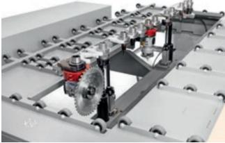
Das in das Maschinenbett integrierte Magazin gewährleistet die Verfügbarkeit von Werkzeugen auch mit automatischen Zuführungslösungen, bei minimalem Platzbedarf.
