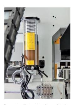
Die automatische Schmierung ist eine Option, die eine ständige Schmierung der wichtigsten Bewegungselemente der Maschine ohne Eingriff des Bedieners gewährleistet.
