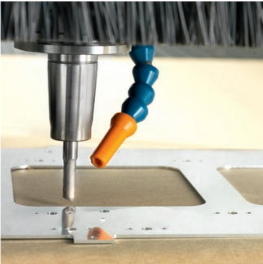
El sistema automático de lubricación de la herramienta con una mezcla de aceite y aire permite mecanizar materiales metálicos no ferrosos y aleaciones ligeras.
