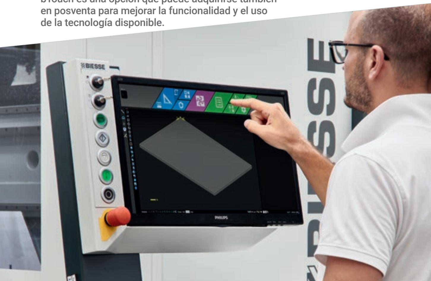
**bTouch es la nueva pantalla táctil de 21,5" que permite realizar todas las funciones efectuadas por el ratón y por el teclado garantizando una interactividad directa entre el usuario y el dispositivo.**
