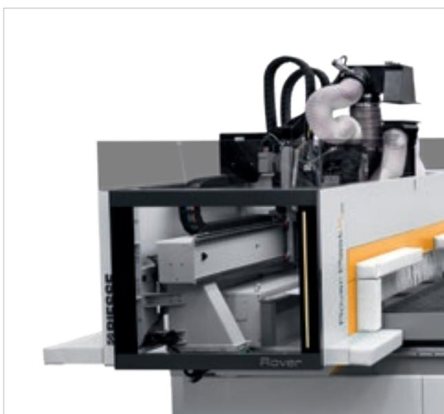
L'ampio sportello apribile garantisce la massima visibilità di lavorazione e facilità di accesso ai gruppi operatori.
