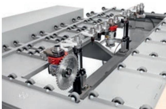
Il magazzino integrato nel basamento garantisce disponibilità di utensili anche con soluzioni di carico automatico, in un minimo ingombro.
