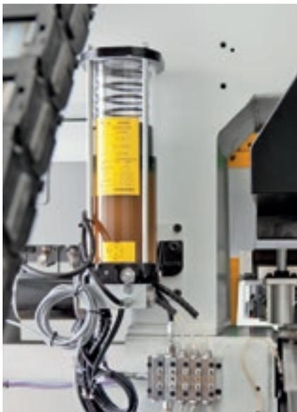
La **lubrificazione automatica** è un'opzione che garantisce una continua lubrificazione dei principali organi di movimentazione della macchina senza richiedere l'intervento dell'operatore.
