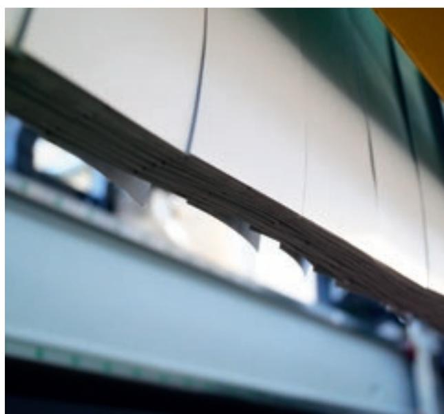
Strati sovrapposti di bandelle laterali a protezione del gruppo operatore.
