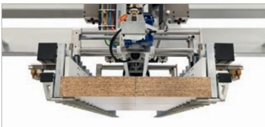
El bastidor de pinzas con presor garantiza la recogida de paquetes tanto en una fila como en fila doble.
