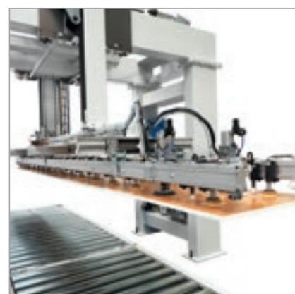
La personalización de la máquina con bastidor de ventosas permite elaborar las barras que se seccionarán.
