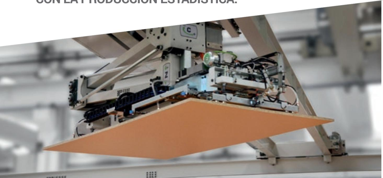
El **sistema giratorio de recogida del tablero** y las **fotocélulas de escuadrado** optimizan el espacio dentro del almacén garantizando una alineación perfecta de la pila y corrigiendo el posible error de la carga manual.
