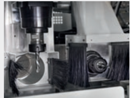
Die Maschine kann mit einer horizontalen und vertikalen Fräseinheit für spezielle Bearbeitungen von Rillen, Taschen, Schlitzen und Bearbeitungen für Lamello Clamex ausgestattet werden.
