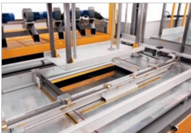
Piastra adattiva permette di bloccare anche lastre di piccolo formato in modo automatico.
