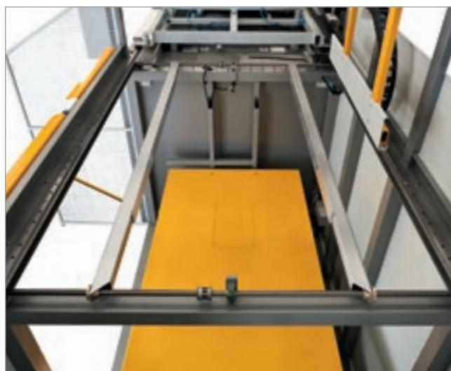
Il dispositivo di centraggio consente di regolare la giusta posizione della lastra automaticamente.
