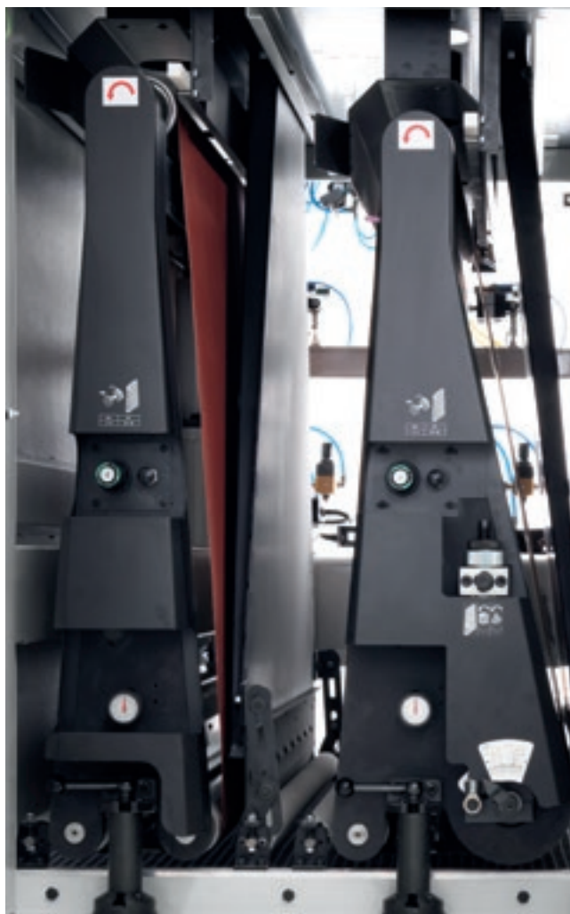
Версия с комбинированной группой ролик/утюжок.
