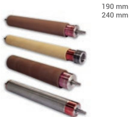
La máquina se puede equipar con rodillos de acero o de goma de 90 Sh, con diámetro de 190 o 240 mm, para efectuar operaciones de calibrado y dotados de motores de 25 Hp.
