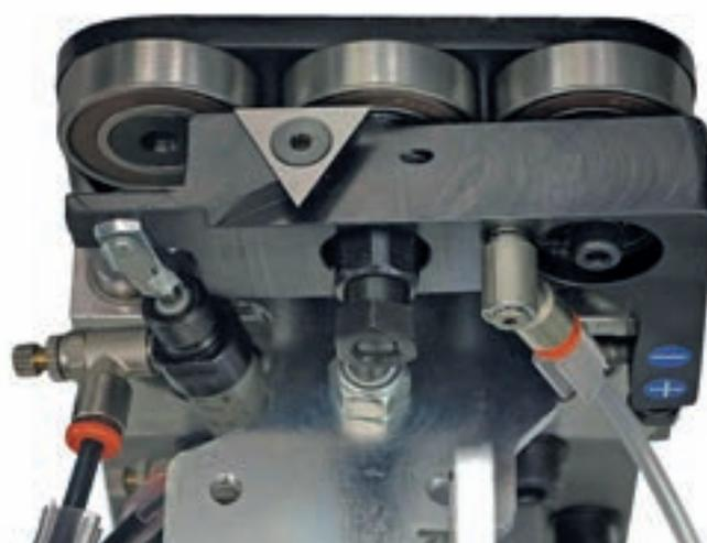
Il **Gruppo Rachiacolla** che rimuove gli eccessi di colla nella parte superiore ed inferiore del pannello, è l'unico sul mercato dotato di 4 cilindri pneumatici per un'elevata qualità di finitura.
